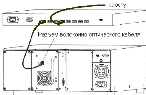
Рисунок 4. Кабели FC, соединяющие два накопителя к коммутатору
